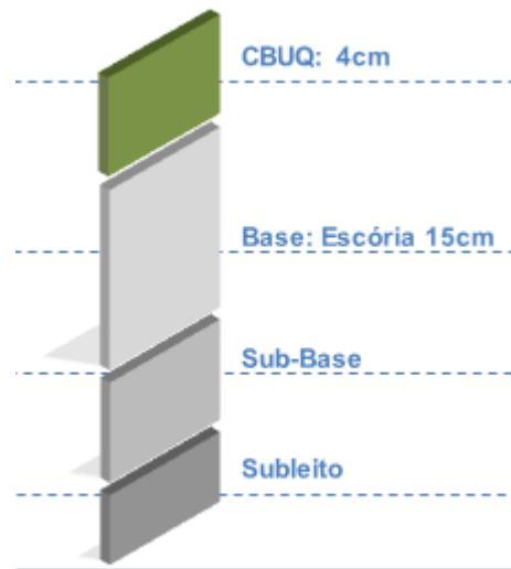
Figura 8 – Pavimento asfáltico com o agregado siderúrgico (proveniente da escória)
