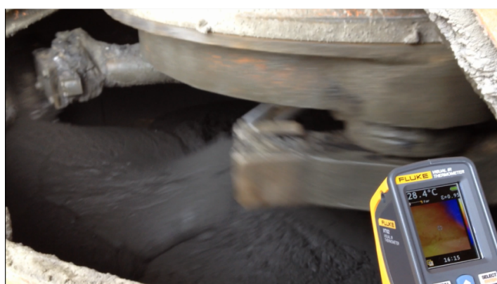
Figura 3 - Mistura do compósito cimentício avançado.
