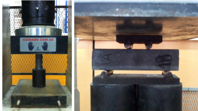
Figura 2: Ensaios de resistência à tração na flexão e resistência à compressão
